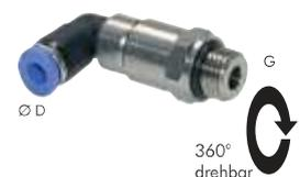
\* Diese Anschlüsse nur mit Luft verwenden. Sie sind weder geeignet für die Verwendung mit Wasser oder anderen Flüssigkeiten noch mit anderen Gasen außer Luft. Die Anschlussstücke sind mit einem Schlüssel am Sechskant des Zapfens anzuziehen. Betriebsdruck: max. 10 bar, sowie Grobvakuum, Temperaturbereich: 0°C bis max. +60°C
